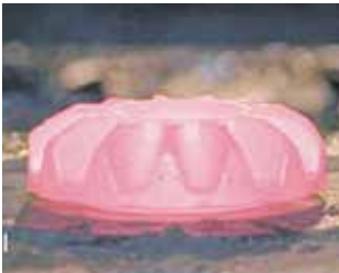
Так выглядит прецизионная штамповка поковки спутника с окончательно оформленным зубом
