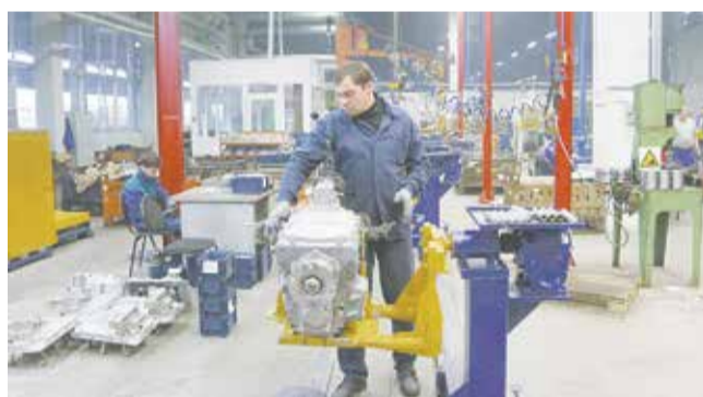
На сборочном участке собирают около 50 различных моделей коробок передач
