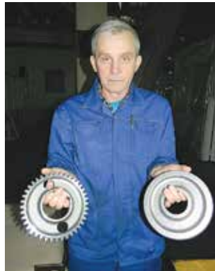
Старожил бригады Виталий Конов: в правой руке заготовка, а в левой — уже готовая шестерня
