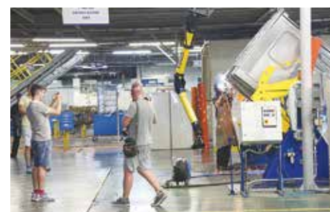
На ПРЗ блогеры увидели цех сборки-сварки кабин для новейшего модельного ряда автомобилей КАМАЗ и роботизированный комплекс сварки крыши кабины
