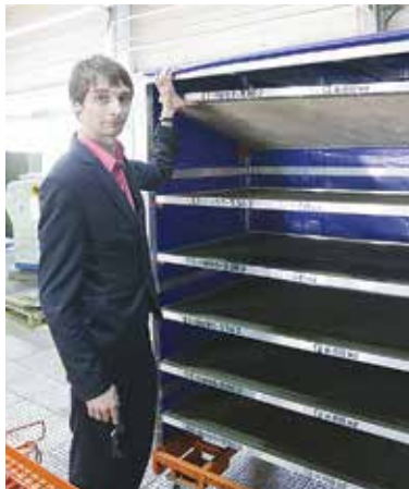
Михаил Герасимович специализируется на разработке конструкций спецтар. Этот стеллаж используется на литейном заводе для перевозки стержней
