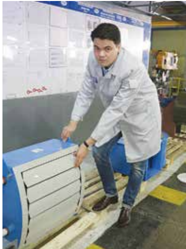
Одним из авторов новой партии воздушно-отопительных агрегатов стал инженер-конструктор Алмаз Назмиев. В этих вентиляторах угол воздушного потока можно регулировать рукой
