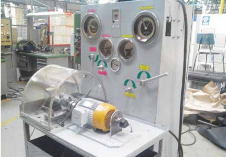
Стенд испытания масляных насосов всех типов — одно из последних детищ когда с «Евро-0» до «Евро-4» реорганизация шла.
