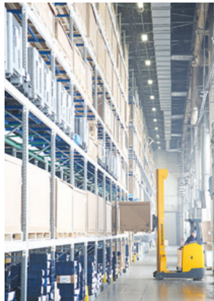
Семиетажные стеллажи обслуживают высотные штабелёры, которые могут поднимать груз на высоту больше шести метров
