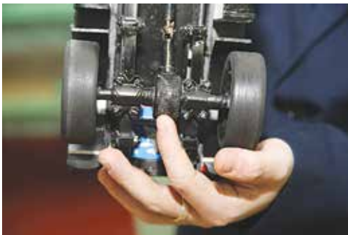
Вспомогательный карданный вал — часть его сделана из пластиковой крышечки от бутылки
