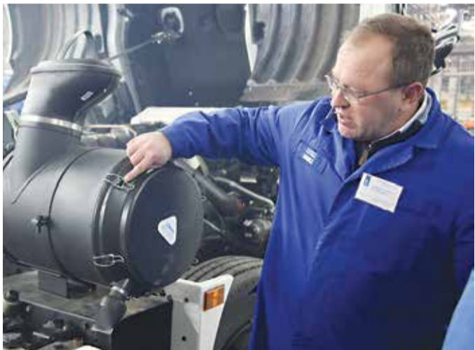
Поставщик изменил прямой угол защёлки крепления на скобах — ушла проблема по воздушному фильтру
