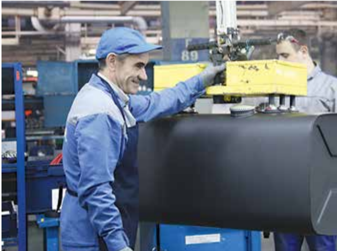
Слесари МСР Фарит Гариев и Александр Борзихин при установке топливных баков теперь только управляют пультом
