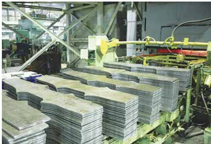
Штамповка полубалки из штучной карточки 370x1650 мм уйдёт в прошлое
