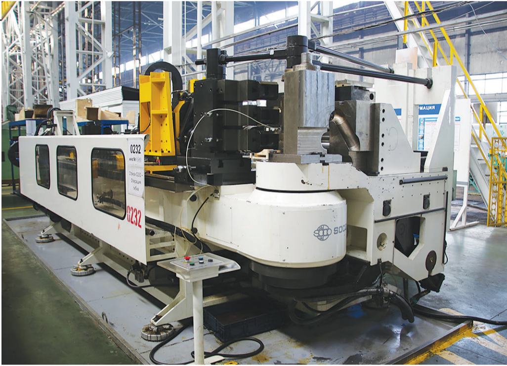
Станок СВ-80 работает с трубами диаметром от 32 до 60 мм, а СВ-130 гнёт трубы диаметром от 80 до 130 мм
