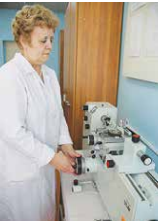
Поверка линейно-угловых средств измерений проходит в специальных помещениях с соблюдением температурного режима
