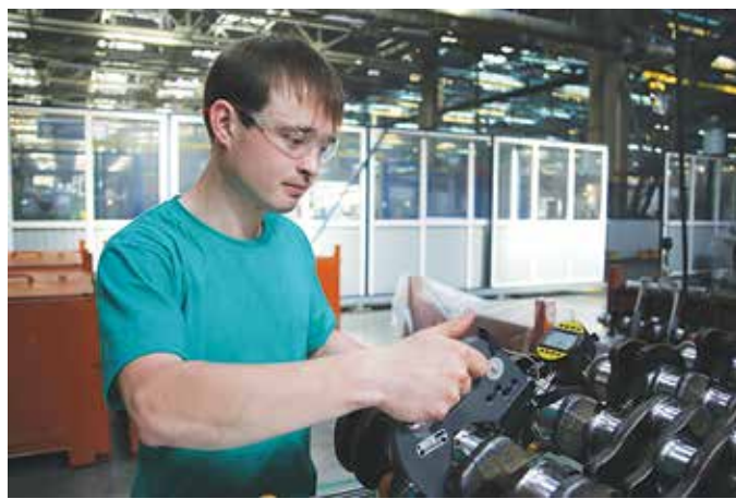
Радик Лофтрахманов проводит визуальный осмотр деталей и проверяет диаметры
