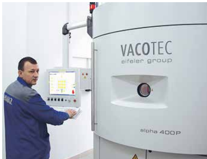
Перед работой камеру установки пылесосят, фланцы двери протирают спиртом, так как попадание на уплотнитель аппарата даже малейших частиц кожи или волос ведёт к утечке вакуума. На фото: оператор вакуумных установок Александр Иванов
