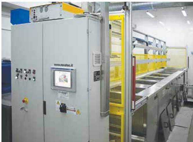
Место, где грязный инструмент становится чистым. Робот последовательно окунает инструмент в семь «ванн» с разными мощными растворами и специально подготовленной водой
