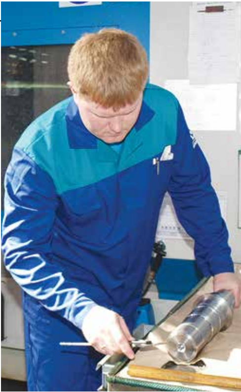
Сергей Лазаренко, наладчик станок с ЧПУ 6-го разряда: «В процесс обработки трижды делаются замеры, раз в час проводится выборка трёх деталей подряд. Кроме того, у каждого есть индивидуальный клеймо, человек отвечает за изготовленную деталь. В случае брака виновник будет найден легко»
