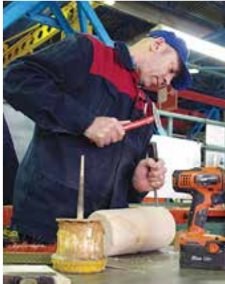
Оснастка из дерева изготавливается быстрее и обходится дешевле, чем из металла
