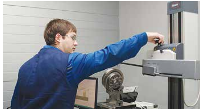
Замеры, которые раньше делали вручную, теперь выполняет приобретённое этим летом высокоточное оборудование, для которого созданы спецусловия: отдельное помещение с постоянной температурой и «подушка» на полу, чтобы не предавалась вибрация от станков
