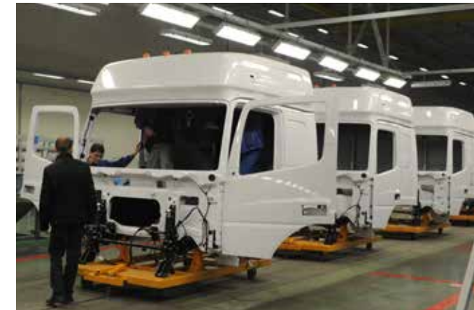
Для приведения нового конвейера в движение не требуется электроэнергия
