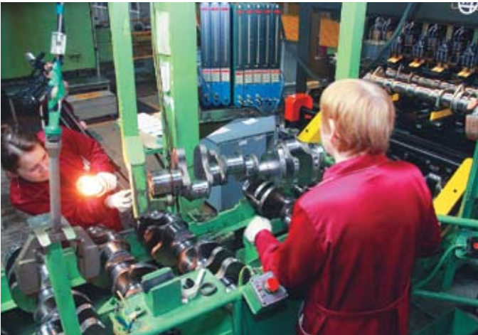
Каким бы ни был современный станок, без человеческого контроля не обойтись. Сразу после Magross'a коленвал осматривают контролёры ОТК
