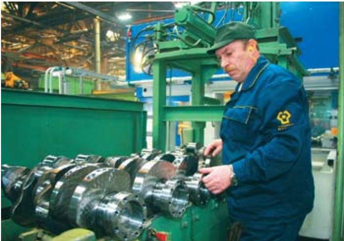
Новый Nagel, заменивший два старых станка, способен полировать по 200 коленвалов за смену
