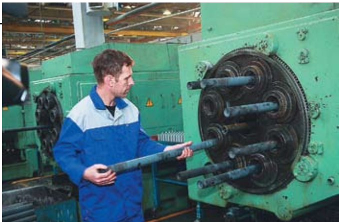
Наладчик автоматических линий Богдан Галета «заряжает» свой токарный автомат трубными заготовками
