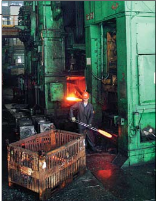
С внедрением универсального блока нагрузка на прессах тяжёлого участка распределяется равномерно
