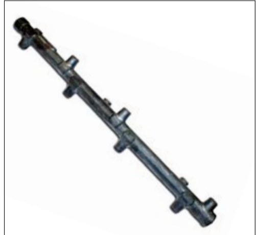
Малый диаметр, большая длина и боковые отrostки, расположенные по всей длине поковки, – отличительные черты выпускаемой ныне кузнечным заводом детали
