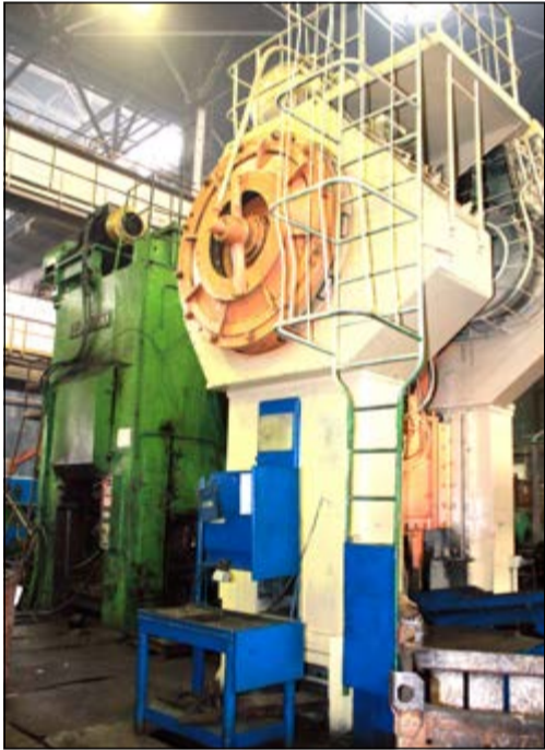
Линия прессов в КПК-1, где штампуется поковка аккумуляторов топлива высокого давления
