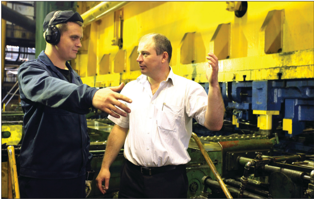
Начальник ЦППД Владимир Ломаев (справа) – оператору Михаилу Паршакову: «Михаил Сергеевич, штамп новый, берегите как зеницу ока! Не забывайте контролировать удаление отходов металла и следить за давлением пресса»
