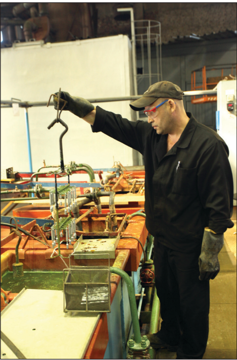
Линия хромирования инструментов, привезённая с КИСМа, подверглась реконструкции и теперь служит как новая
