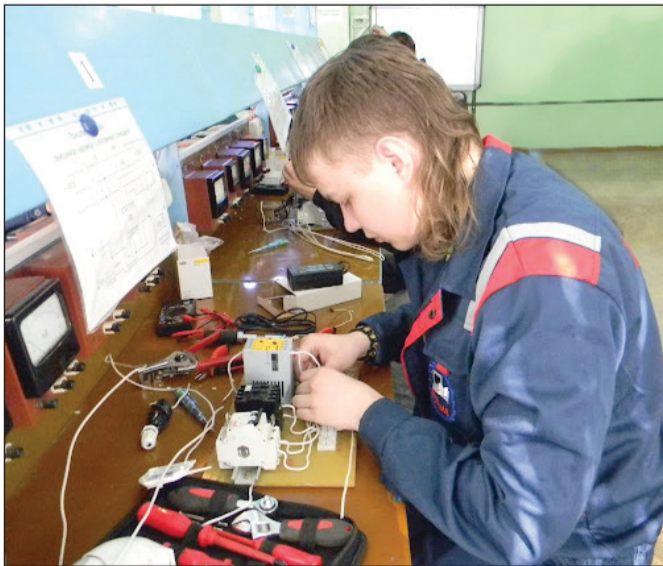
Схема освещения, которую собирают конкурсанты, должна будет реагировать на движение
