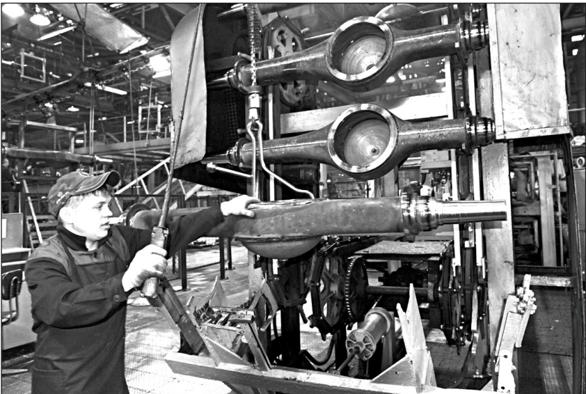
Блок картера почти готов – осталось приварить комплектующие, которые варятся в зависимости от модели автомобиля
