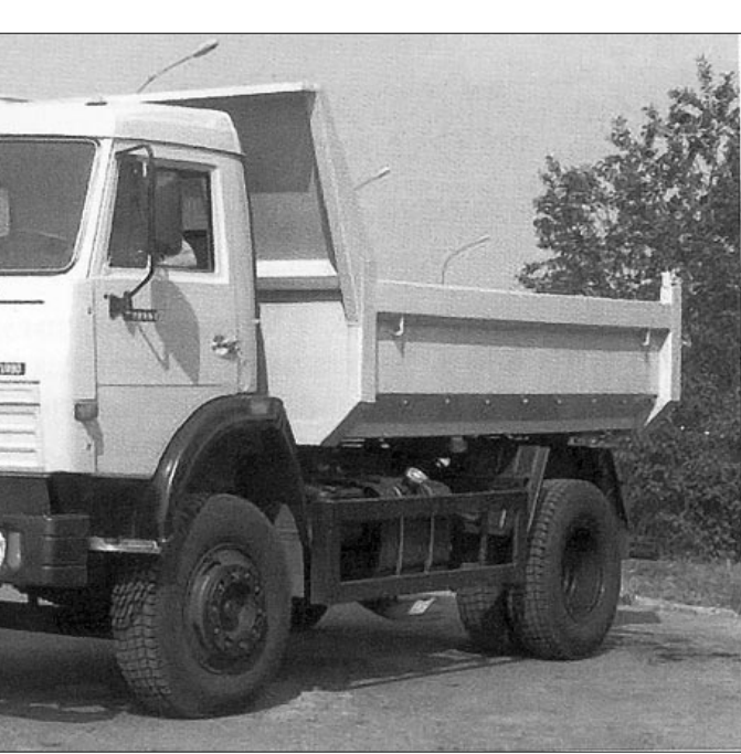
Мал золотничок, да ценен и незаменим: самосвал КАМАЗ-43255 грузоподъёмностью 8 тонн
