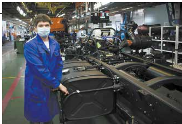
Молодой технолог Азат Гизатуллин уверен — увеличение зазора убережёт от повреждений и ресиверы, и стойку боковой защиты
