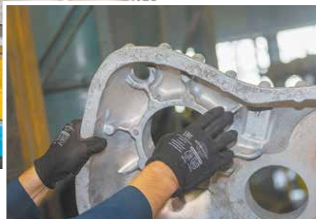
Александр Зорин: «Повысить прочность отливки помогли изменение метода литья и введение рёбер жёсткости в конструкцию»
