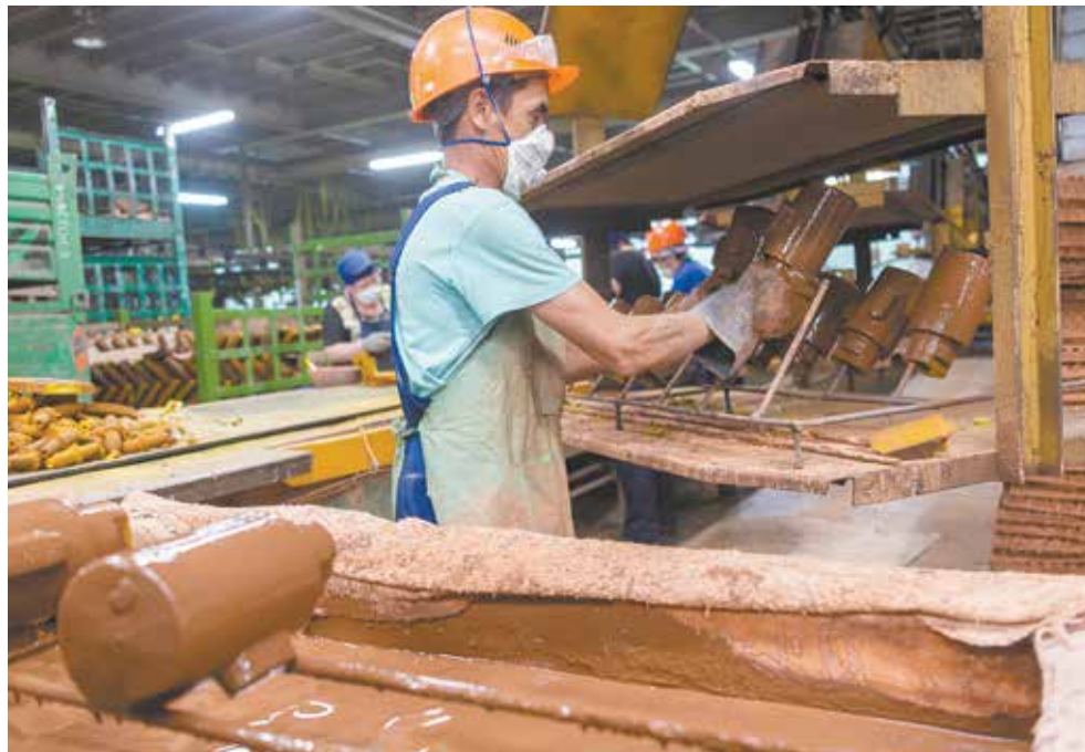
...и устанавливает на подставку подвесного толкающего конвейера. Пока они едут на следующую операцию, драйвер помогает сохранить их покрытие
