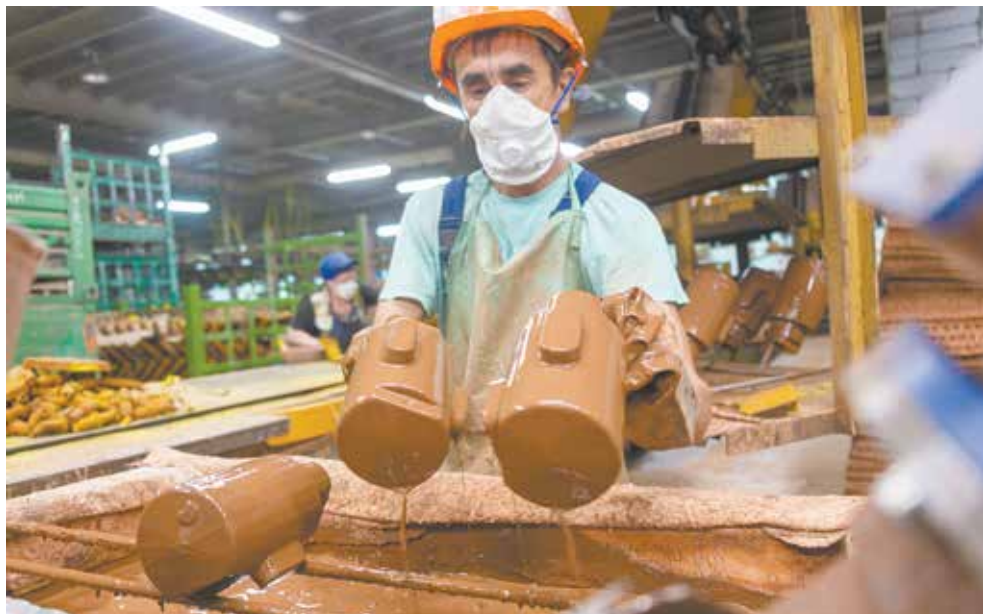
Рабочий окунает стержни в противопопригарную краску...
