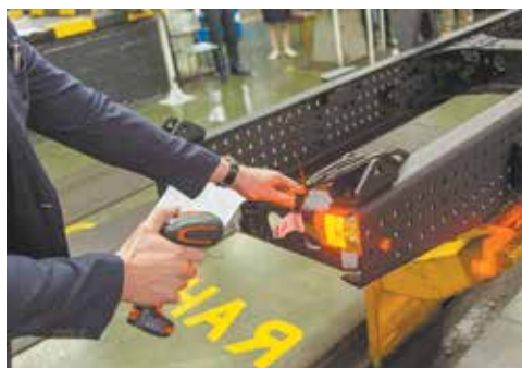
Сборка автомобиля начинается с идентификации рамы
