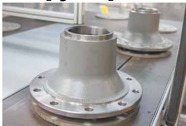
На новой линии будут обрабатывать ступицу переднего колеса для тягачей 54901
