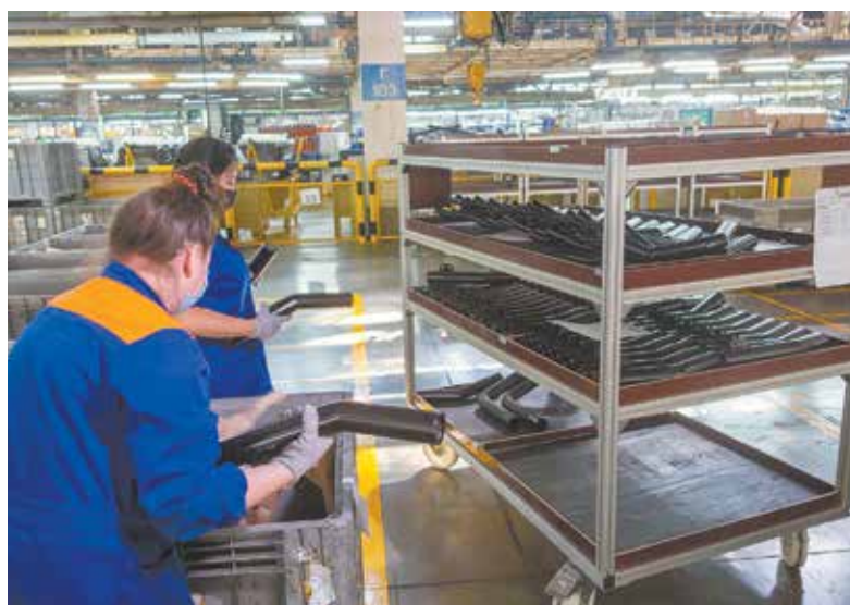
В JIS-тележки комплектующие укладываются в соответствии с очередностью моделей автомобилей, следующих по конвейеру
