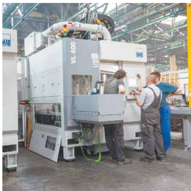
На токарно-обрабатывающем центре EMAG идут пусконаладочные работы
