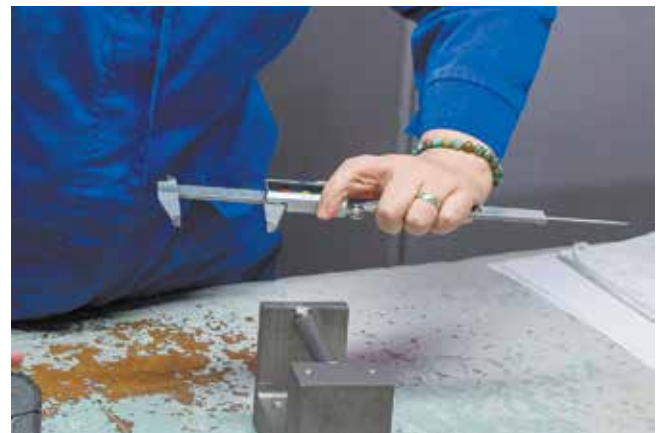
С помощью штангенциркуля делаются замеры оснастки. Только значения вверх ногами
