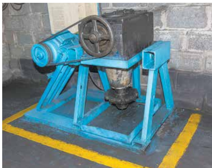
На стенде проводятся не только ремонт и техобслуживание, но и испытания редукторов
