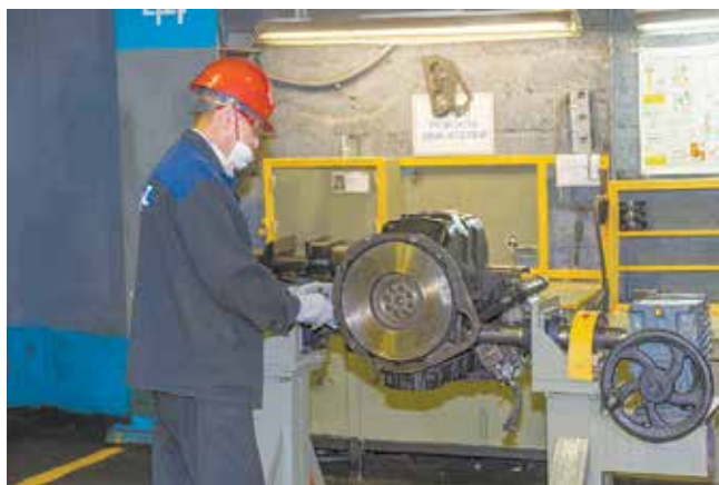
Стенд с поворотным механизмом существенно облегчил труд слесарей-ремонтников
