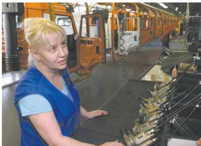
Любовь Максимова, прежде чем установить тормозной кран, проверяет наличие в нём пружинки, которая при эксплуатации обеспечит герметичность. Если она отсутствует, то кран направят в изолятор брака
