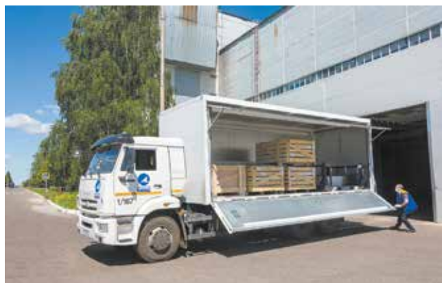
Новая разработка для ускорения загрузки и выгрузки — машина с раскрывающимися боковыми бортами методом «бабочка»
