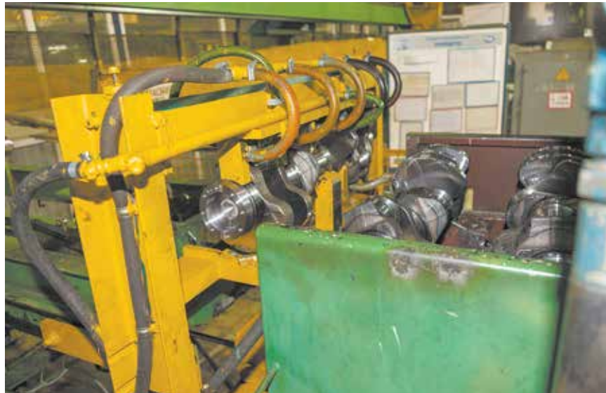
Логичным завершением мойки для коленвалов стала сушка — в новой продувочной системе
