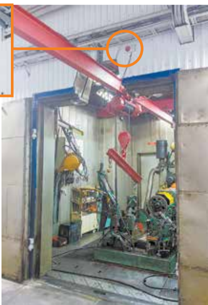
Об открывающихся впереди воротах водителя погрузчика предупредит светозвуковой сигнал
