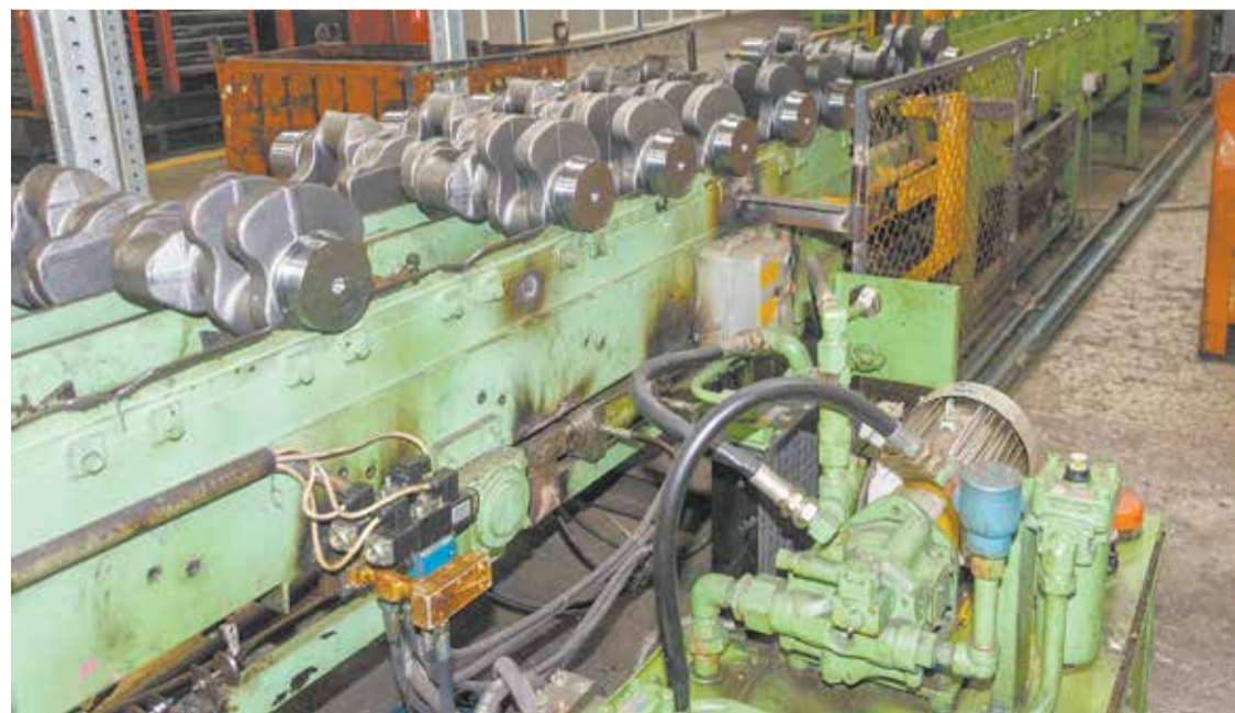
Гидроцилиндр помог сделать работу линии коленвалов более стабильной
