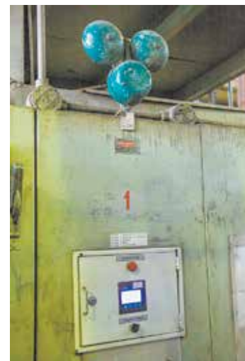
Сигнализация прозвенит, если показатели в печи отклонятся от нормы
