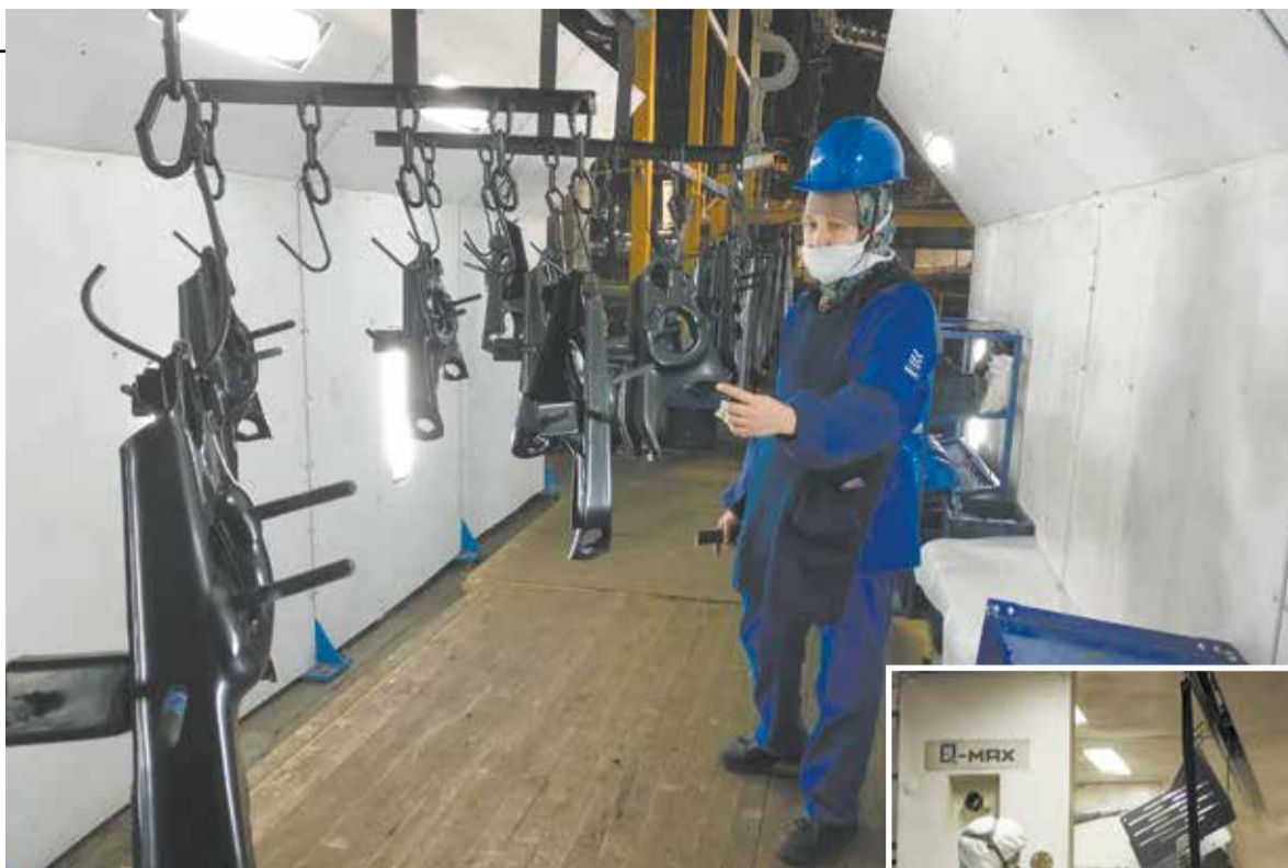
В бестеновой камере на резбовые элементы надеваются специальные колпачки
