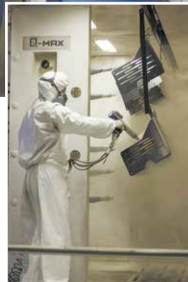
В порошковой камере основную часть работы выполняет автоматика, но и маляру есть чем заняться
