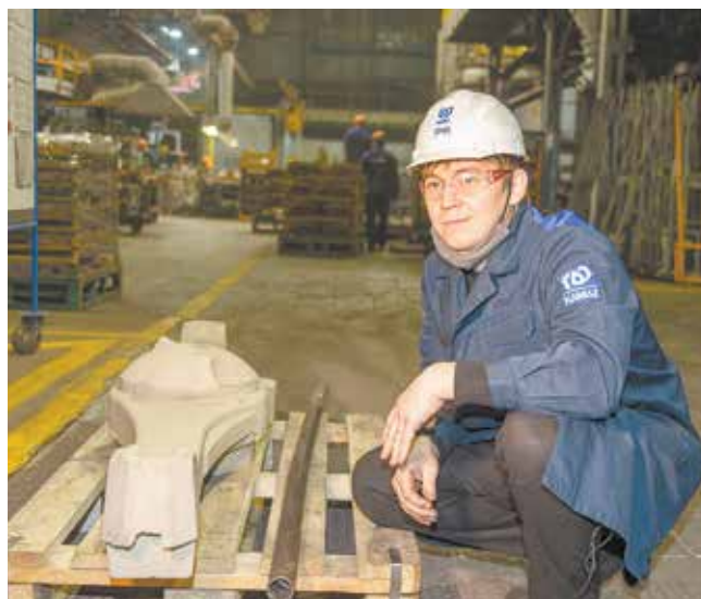
На паллете перед Альбертом Габдулхаковым — доработанный технологами песчаный стержень и уже не используемая в нём стальная труба
