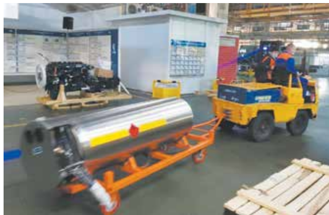
Криобак доставляют на конвейер на специальных тележках
