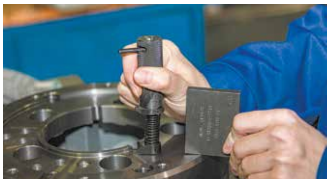
Слева — ранее использовавшийся калибр: из шести комплектующих и пяти различных сплавов. Неточность размера детали показывал подвижный стержень в центре, а определить это можно было только на ощупь. Айну́р Мирса́етов предложил максимально простой и надёжный мерительный инструмент — калибр-пробку с проходной и непроходной сторонами
