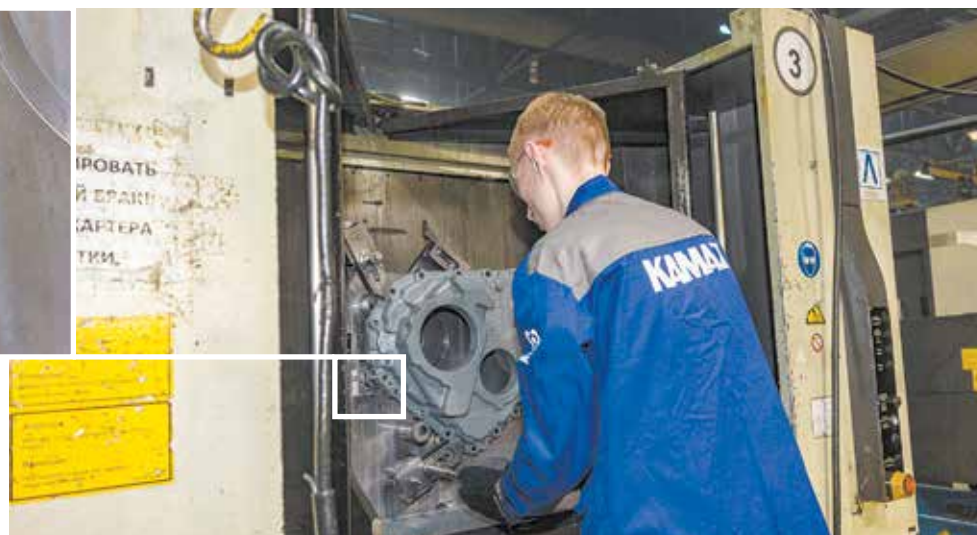
Изменение конструкции двух маленьких упоров помогло решить большую проблему — не допустить течи картера раздаточной коробки
