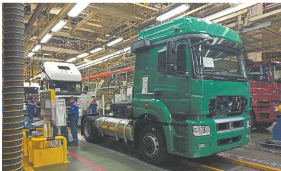
КАМАЗ, работающий на СПГ, собран на конвейере. Осталось только топливо закачать
