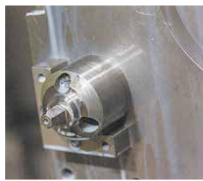
Изменение конструкции двух маленьких упоров помогло решить большую проблему — не допустить течи картера раздаточной коробки
