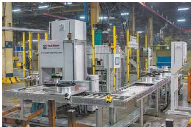
Сборка ступицы с подшипником происходит с контролем усилия и глубины запрессовки — такая технология применяется на «КАМАЗе» впервые
