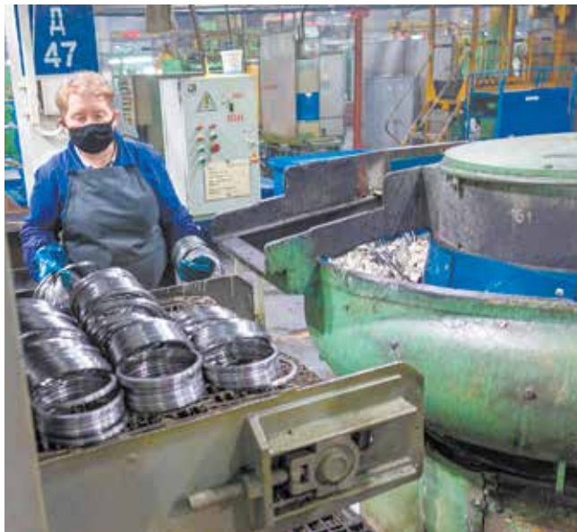
После обработки от заусенцев кольца газового стыка попадают на мойку — пока ещё на старую
