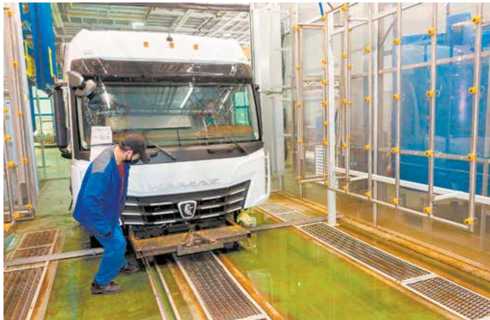
Проверку на герметичность проходит каждая кабина большегруза поколения К5
