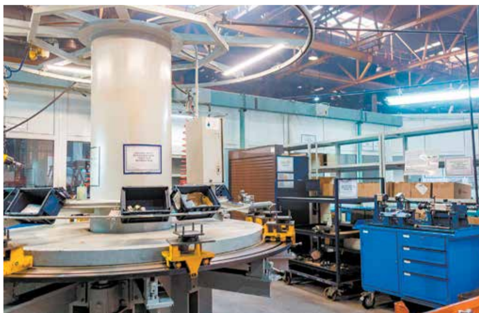
Карусель для редукторов — настоящий аттракцион: спутники не только ездят по кругу, но и сами вращаются
