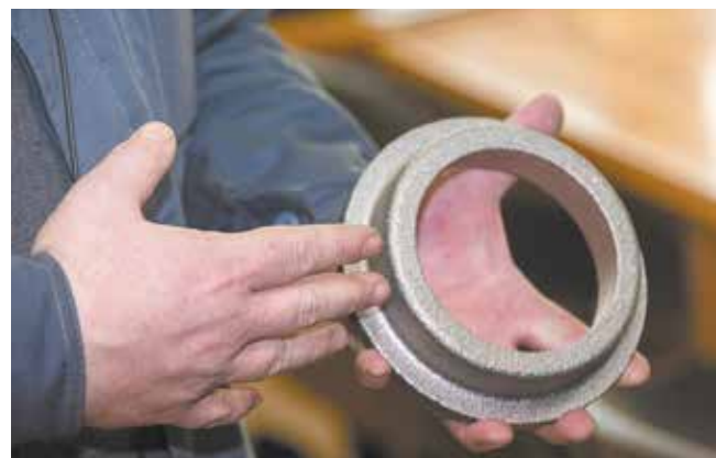
При механической обработке на этой стороне поковки образовывался зажим, но выявить дефект визуально не удавалось
