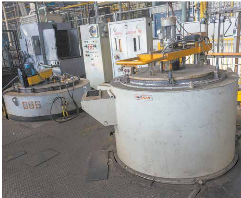
Над полом видна только крышка печи, а процесс азотирования при рабочей температуре до 560°С происходит в шахте
