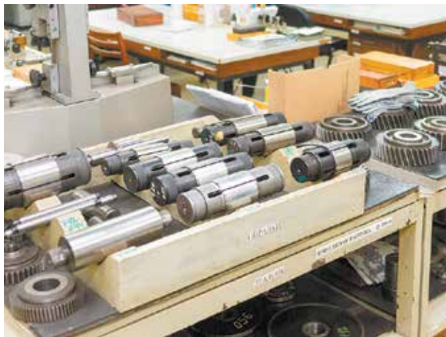
В лаборатории 33Чик на видном месте выставлены эталоны, применяемые для измерения шестерней
