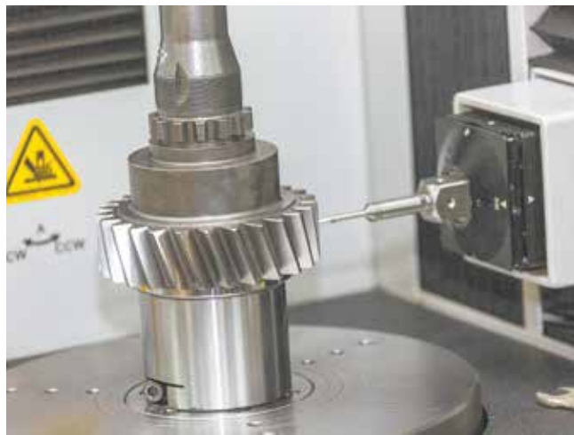
Машина проводит измерения шестерни по 21 параметру, а затем рассчитывает протокол
