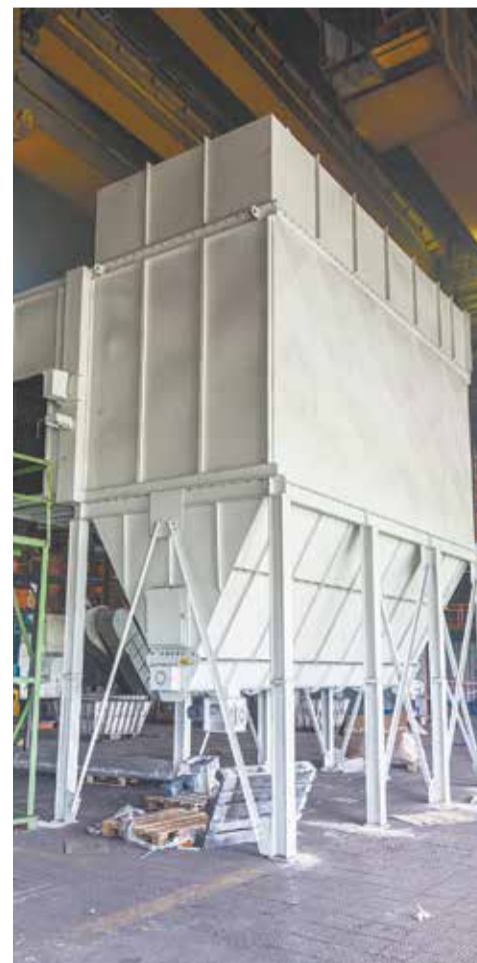
Установка GARANT-Filter очищает воздух, идущий от двух плавильных печей
