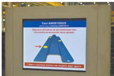
Когда инструкция перед глазами, гайка будет приварена как надо
