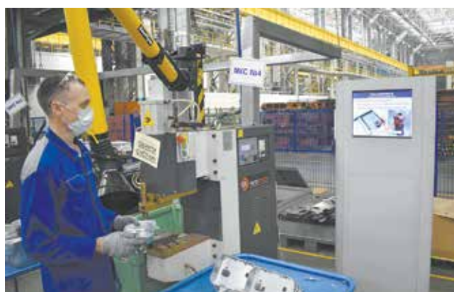
Когда инструкция перед глазами, гайка будет приварена как надо
