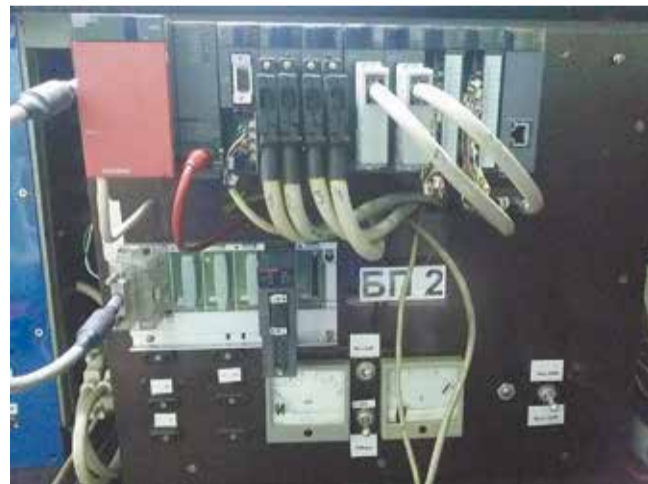
Этот стенд для проверки и ремонта контроллеров команда Олега Иванова придумала и собрала самостоятельно и без материальных затрат
