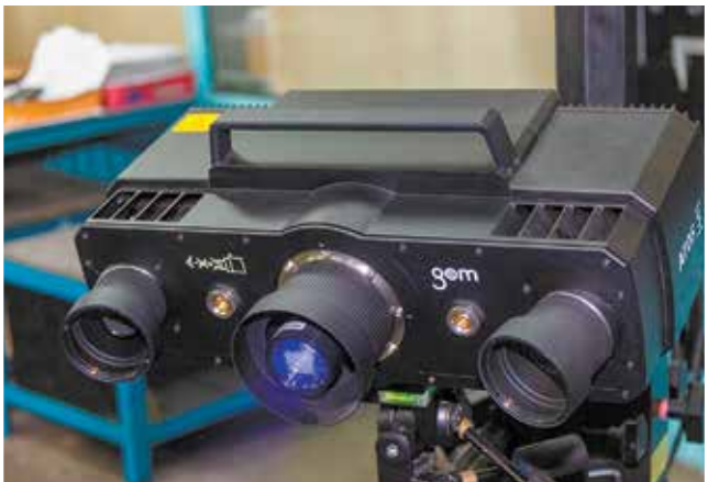
Оптика сканера позволяет замерить и проанализировать отливки больших размеров
