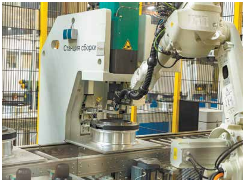
Установка подшипника на ступицу выполняется роботом...
