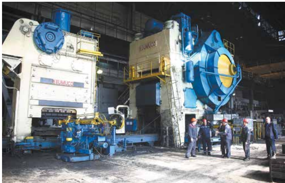
В рамках проекта линия будет оснащена системой быстрой смены штамповой оснастки SMED (Single Minute Exchange of Dies), которая позволит существенно сократить время, затраченное для переналадки производственного оборудования
