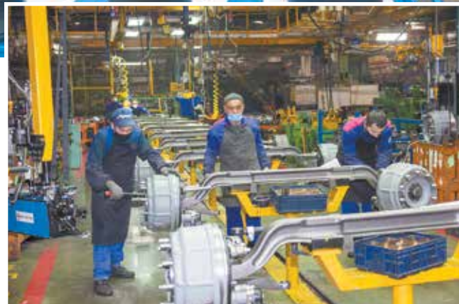
Конвейер сборки передней оси: ось-девятитонник, изготовленная на «КАМАЗе», ничем не хуже покупной
