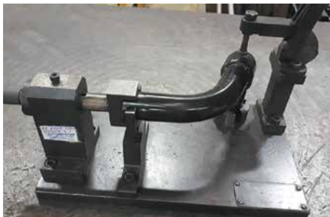
За счёт доработки высотометра Tesa контроль размера детали вместо 50 минут стал укладываться в 18 секунд
